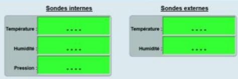
Le module Ethernet n'est plus en liaison avec la partie mesure. Il peut y avoir un problème de communication interne ou la SAI60 est en cours de configuration.
